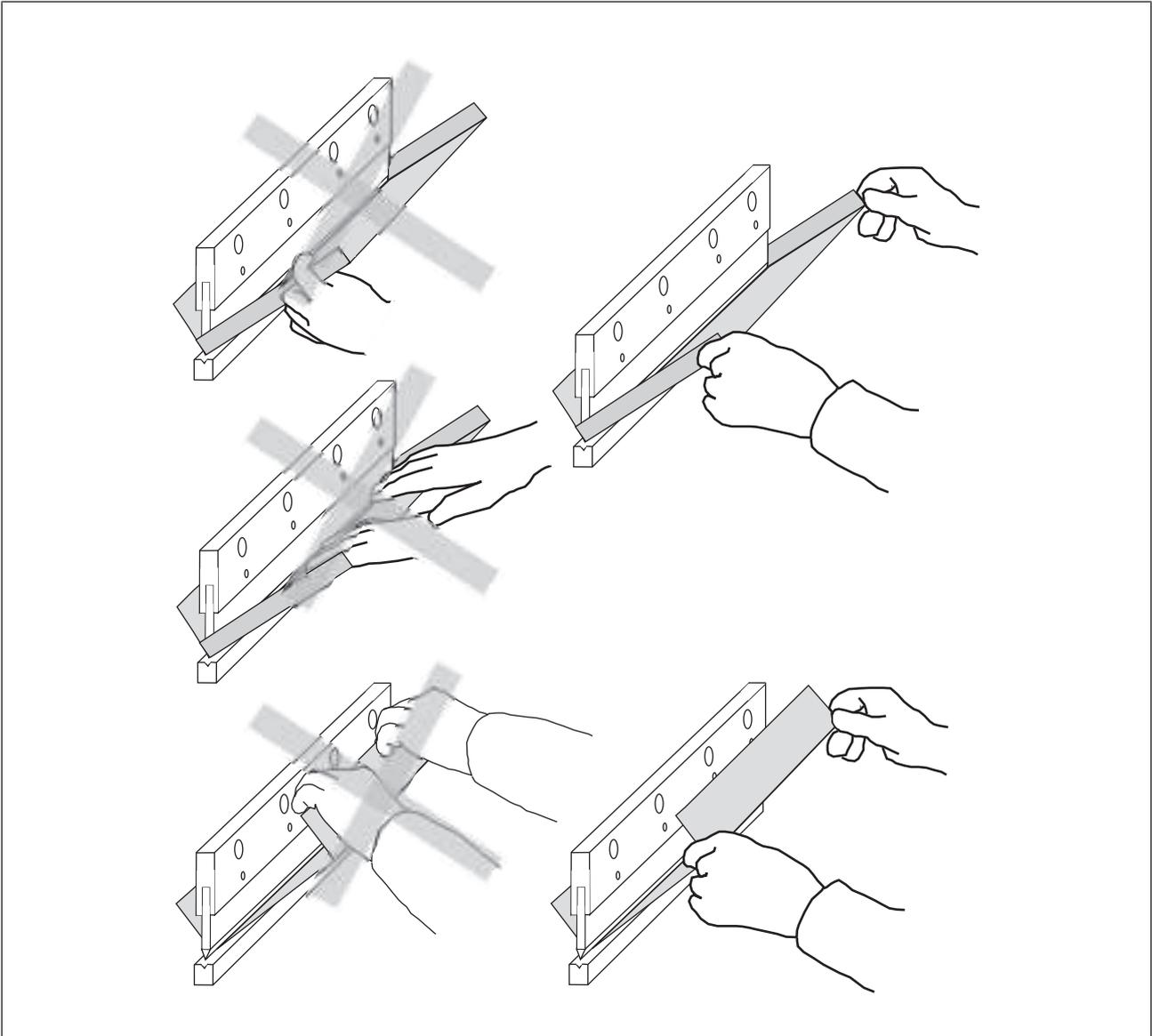
Fig.: Handling box bending
